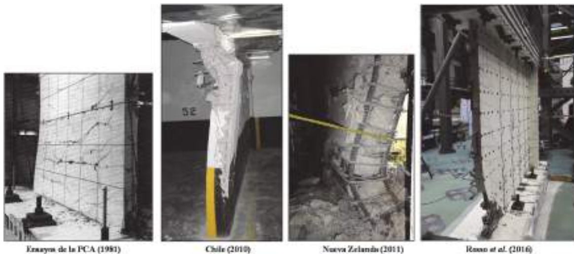
Figura 2. Evidencias en laboratorio y campo de inestabilidad lateral de muros delgados de concreto reforzado.
